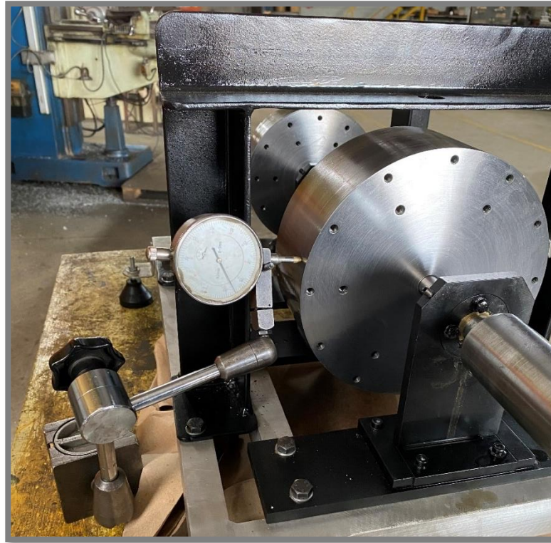
Figura 39 - Run Out de alinhamento dos rotores verificado com relógios comparadores.
