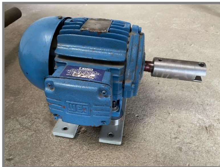
Figura 35 - Motor trifásico WEG 1720 RPM e 2 CV.
